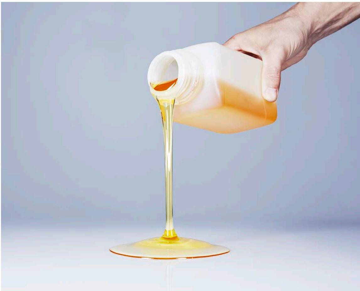
Die Harze sind untereinander mischbar zur flexiblen Einstellung der Viskosität. Des Weiteren stehen zwei Katalysatoren zur Verfügung. Ein Katalysator mit schneller Aushärtung und einer mit langsamer Aushärtung. Diese sind ebenfalls untereinander mischbar und ermöglichen daher eine flexible Einstellung der Topfzeit. Nach Zugabe des Katalysators härtet das Material bei Raumtemperatur aus.
